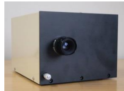
弊社製 分光イメージングカメラ標準測定システム SPECT-CAM-100vis, nir1
