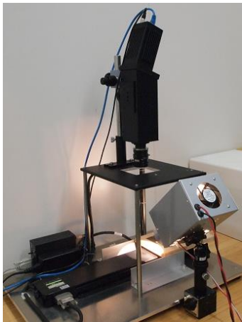
AVAL DATA CORPORATION 製ハイパースペクトルカメラ(InGaAs1300 ~ 2150nm)インラインで全数の非破壊検査ができます。弊社は心臓部にあたる分光イメージングユニットを開発
